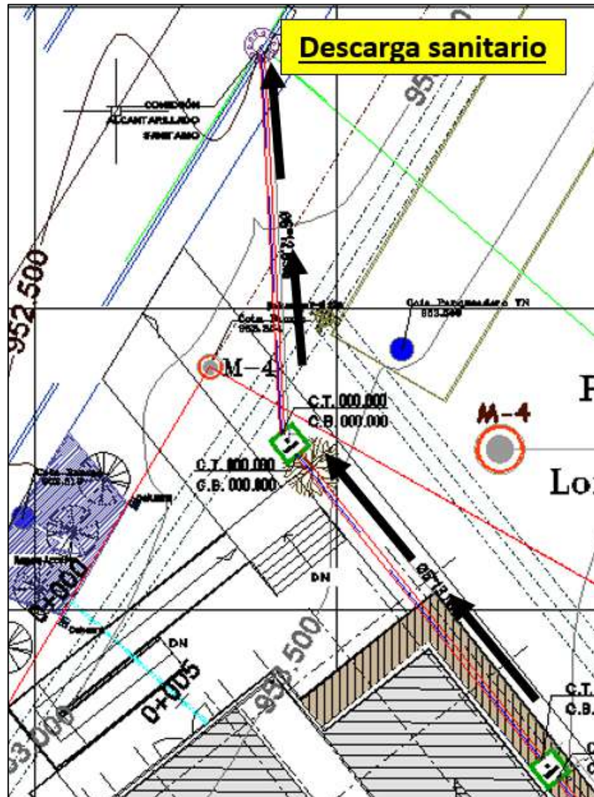
Figura 6. 5. Redes alcantarillado proyectadas.
