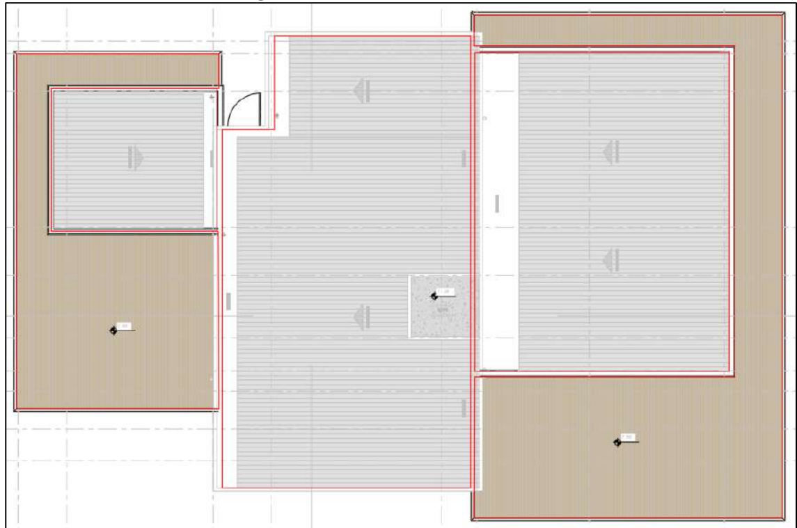
Figura 7-1. Sectorización áreas cubierta.
