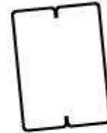
Correas en perfil COLMENA PCC 2x220x80 x 2.5 mm
